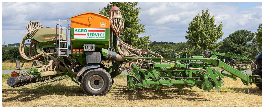
Die Primera DMC baut in Arbeitsstellung 8,40 m lang und ist sehr massiv.
