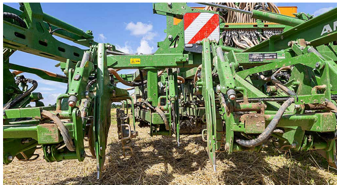
Die Scharanordnung mit schrägen „Tunneln“ soll Verstopfungen vermeiden.
